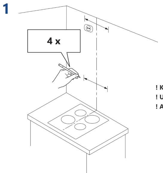
! Käytä kiinnitykseen seinämateriaaliin sopivia kiinnikkeitä.
