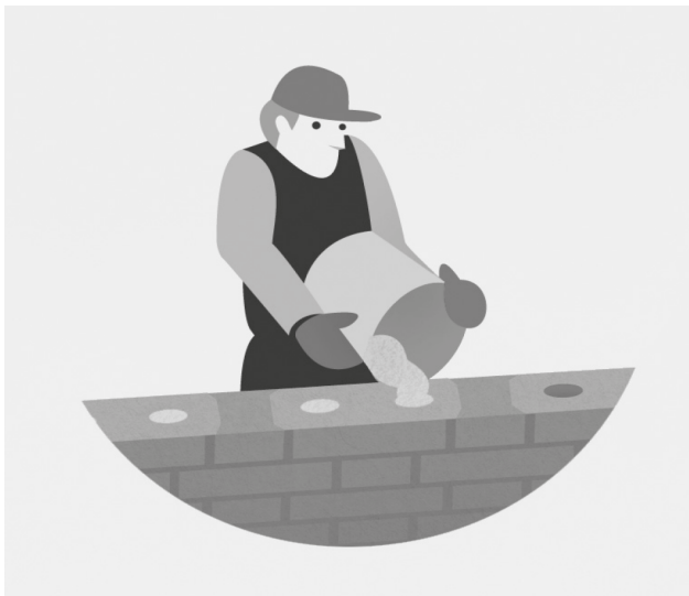
Kuva 8. Yli 750 mm korkeat muurit tehdään teräsbetonianturan varaan, muurin reiät raudoitetaan ja lopuksi reiät valetaan betonia täyteen.
