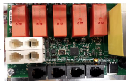
Afbeelding 5 . Volgorde van RJ10-stekkers. Sensor, deurschakelaar, afstandsbediening, extra NTC
