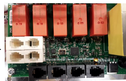
Рис 5 Расположение разъемов RJ 10. Датчик, дверной выключатель, дистанционное управление, дополнительный датчик NTC
