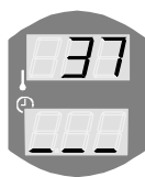
Kivitilan lämpötila paljon viileämpi kuin asetettu lämpötila
