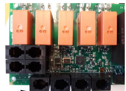
Illustration 6 . Ordre des connecteurs RJ 10. Capteur, interrupteur de porte, télécommande, capteur NTC supplémentaire.
